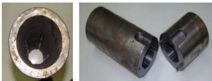
Figura 20: Matriz e cilindro de saída utilizado para a produção de briquetes na extrusora.
