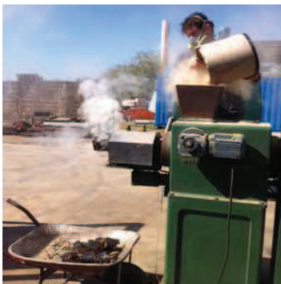
Figura 26: Produção dos briquetes de folhas de bananeira em extrusora empregando matriz com ângulo de entrada de 8^\circ .
