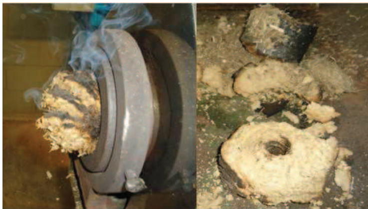
Figura 24: Resultado da produção briquetes de folhas de bananeira com granulometria maior que 3,50 mm em extrusora empregando matriz com ângulo de 8°.
