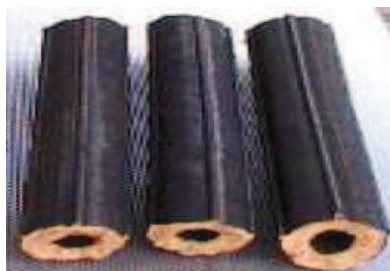
Figura 7: Briquetes de prensa de parafuso com matriz de seção circular.
