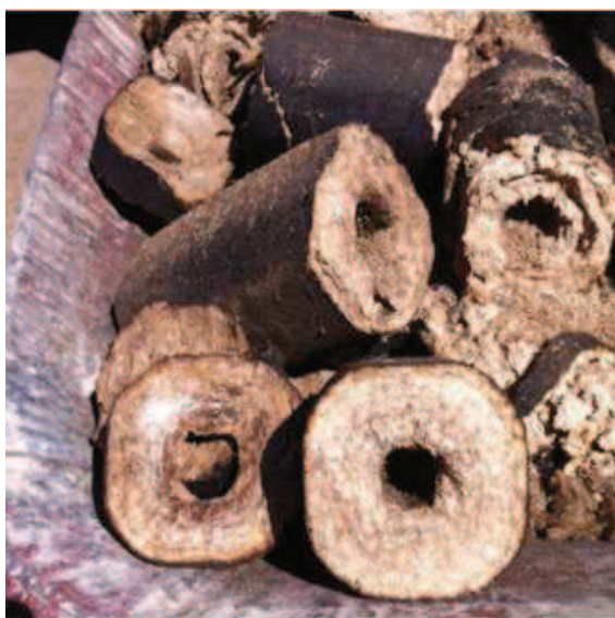
Figura 27: Briquetes de folhas de bananeira com granulometria menor que 1,70 \text{ mm} produzidos em extrusora empregando matriz com ângulo de 8^\circ .
