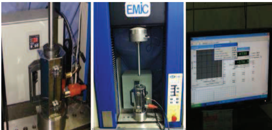
Figura 16: Dispositivo de ensaio de compactação com controle de temperatura.
