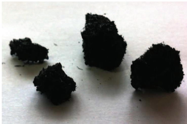
Figura 29: Carvão formado durante a torrefação com temperaturas de 250 e 280 °C.
