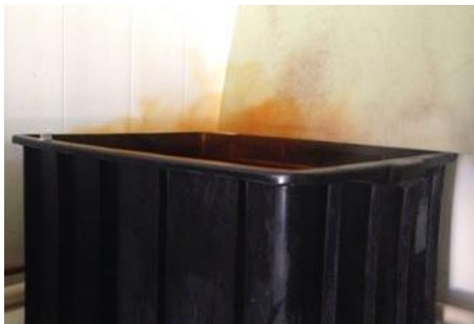
Figura 8 - Tanque com ácido nítrico utilizado para a decapagem das peças.
