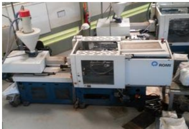
Figura 7 - Máquina injetora utilizada para produção das peças.
