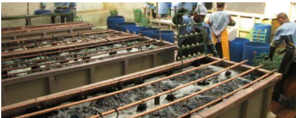
Figura 3 - Processo de cromagem industrial demonstrando os banhos e as gancheiras com as peças.
