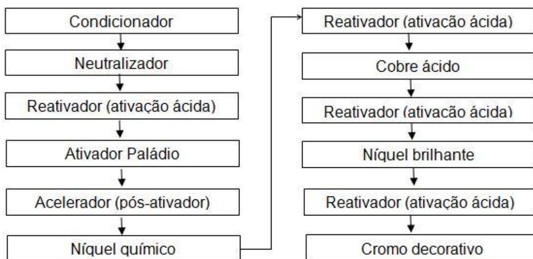
Figura 4 - Fluxograma do processo galvânico.
