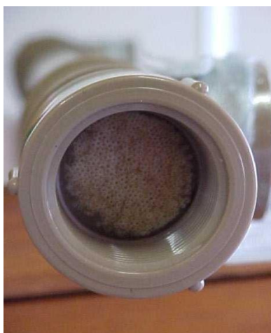
Figura 10 – Membrana de fibra oca.
