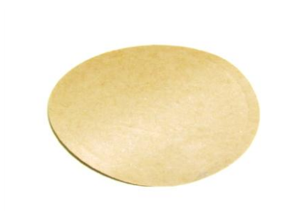
Figura 16 - Membrana plana de Poli(dimetil siloxano).
