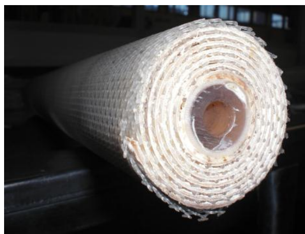
Figura 8 - Membrana em espiral.
