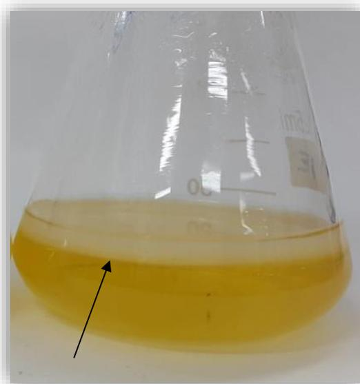
As membranas formadas sem a adição dos aromas, decorrido os 12 dias, passaram por um processo de purificação antes da incorporação *ex situ*. A figura 6 demonstra as membranas durante o processo de incorporação dos aromas e NpAg.
