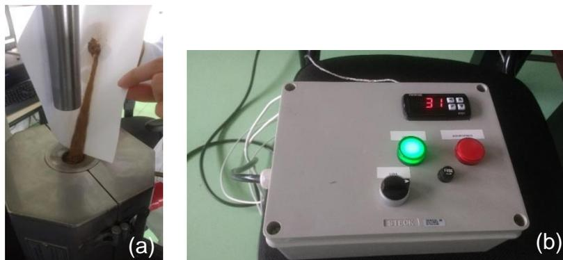
Para os ensaios de compactação, foram empregadas pressões de 60, 90 e 120 MPa e temperaturas de 30, 60, 90 e 120 °C. A velocidade de compactação foi de 200 mm/min. Na Tabela 4 estão apresentadas as variáveis independentes e de resposta do processo de compactação. O estudo resultou num total de 12 experimentos, todos em triplicata.
