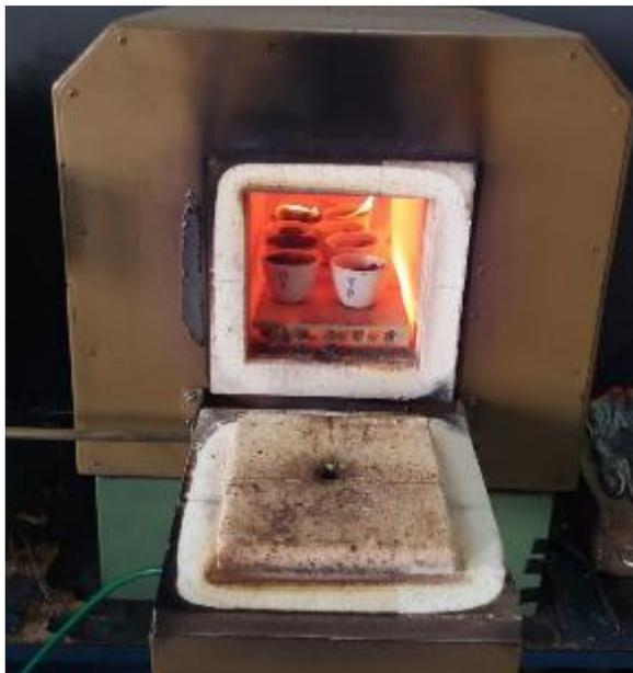
Figura 28: Sistema de resfriamento com gás N<sub>2</sub>. (a) Mufla Formitec e (b) Resfriamento com gás N<sub>2</sub>.
