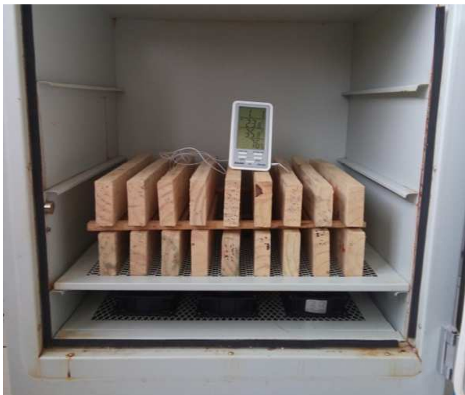
Figura 18 - Interior da estufa mostrando o anemômetro digital empregado no ajuste da velocidade do ar de secagem e a disposição dos dezoito corpos de prova intercalados por um corte tangencial e outro radial.
