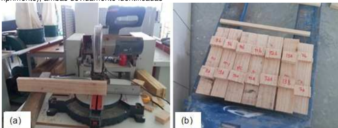
Figura 14 - (a) Serra de bancada utilizada para o corte final dos corpos de prova (peças de maior comprimento) e (b) amostras para determinação do teor de umidade inicial (peças de menor comprimento), ambas devidamente identificadas
