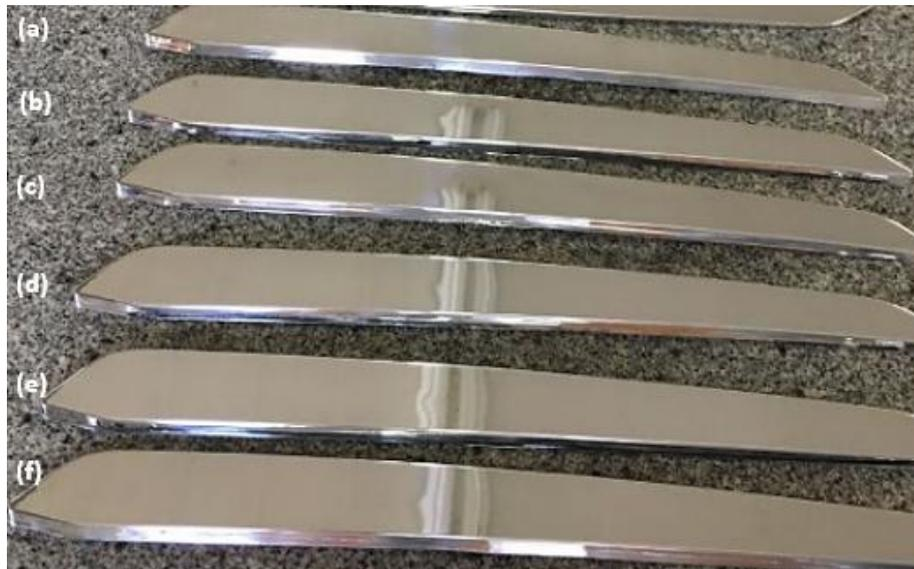
Observa-se na Figura 28, que as peças cromadas submetidas ao ensaio de resistência química ao álcool etílico, não apresentaram defeitos na camada metálica, como manchas, bolhas e corrosão. O resultado se mantém para os demais fluidos utilizados, indicando que não houve reações entre os fluidos e a camada metálica e que as peças apresentaram uma boa adesão da camada metálica.
