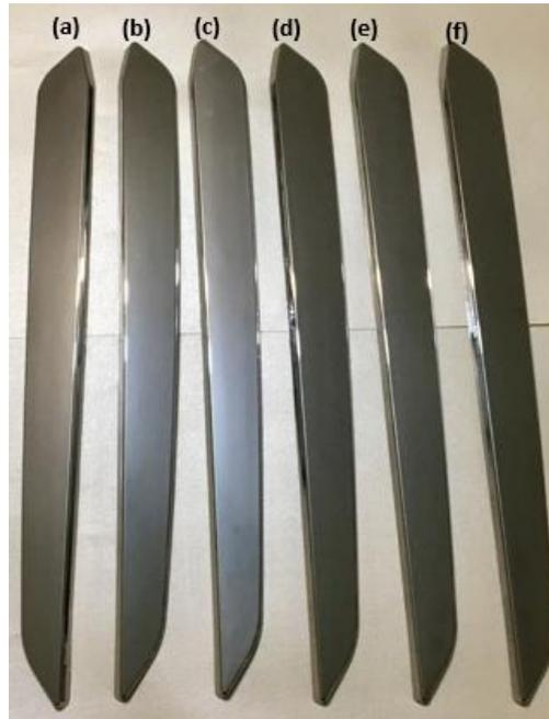
Observa-se na Figura 24, que todas as amostras foram aprovadas no ensaio de choque térmico, pois não apresentaram deslocamento, riscos, manchas, bolhas, entre outros defeitos visuais na camada metálica.
