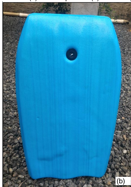
Figura 32 - Prancha prototipada a partir de resíduo de PUR. (a) Parte superior e (b) fundo da prancha.
