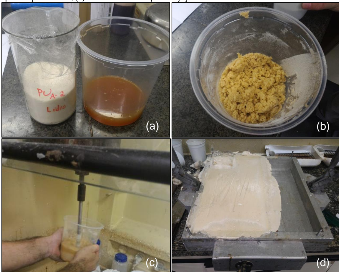
Figura 17 – Confeção das amostras de PUR reciclado: (a) resíduo de PUR moído e resina com AEA para preparação da amostra A_10; (b) Materiais misturados e homogeneizados; (c) homogeneização após adição do MDI; (d) molde aberto 1h após a injeção.
