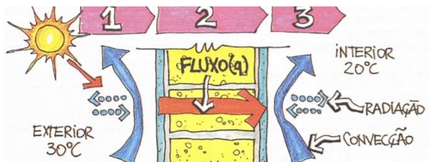
Figura 16: As três fases de transmissão de calor em fechamentos opacos.
