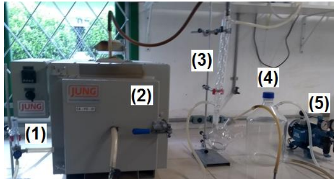
Figura 08 – Forno mufla adaptado para trabalho em atmosfera inerte.
