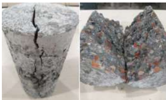
Figura 72 – Ruptura em corpos de prova cilíndricos após o ensaio de tração por compressão diametral
