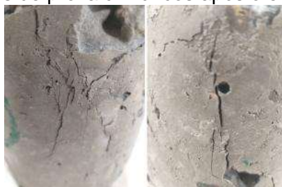
Figura 70 – Ruptura em corpos de prova cilíndricos após o ensaio de compressão
