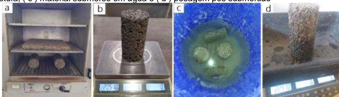
Figura 58 – Sequencia ensaio de porosidade: ( a ) material na estufa, ( b ) pesagem pós estufa, ( c ) material submerso em água e ( d ) pesagem pós submersão
