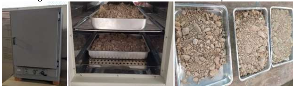
Figura 25 – Secagem da amostra em estufa e esfriamento à temperatura ambiente.
