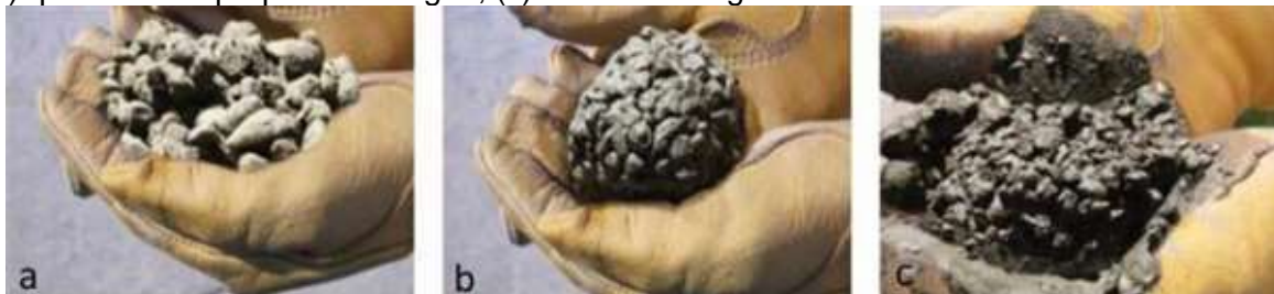
Figura 5 – Amostras de concreto permeável com diferentes teores de água: (a) pouca água, (b) quantidade apropriada de água, (c) demasiada água.
