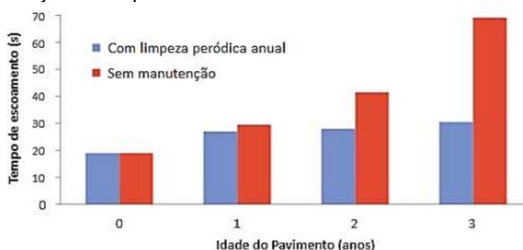
Figura 14 – Evolução da colmatação em pavimentos permeáveis com limpeza periódica anual e sem manutenção da limpeza.
