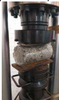
Figura 52 – Corpo de prova cilíndrico posicionado para a realização do ensaio
