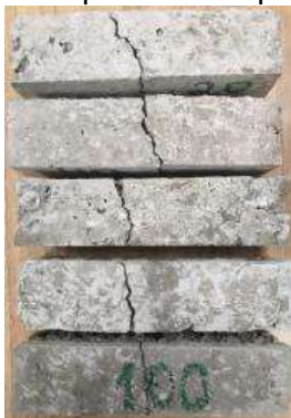
Figura 74 – Ruptura em corpos de prova prismático após o ensaio de tração na flexão
