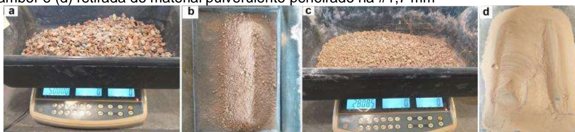
Figura 35 – Etapas do ensaio de abrasão de Los Angeles: (a) 5 kg do material colocado no tambor, (b) material retirado pós rotação no tambor, (c) pesagem material pós rotação no tambor e (d) retirada do material pulverulento peneirado na #1,7 mm
