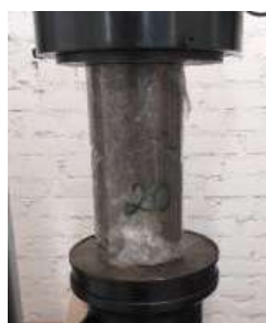
Figura 50 – Corpo de prova posicionado para o ensaio de compressão envolto com plástico filme
