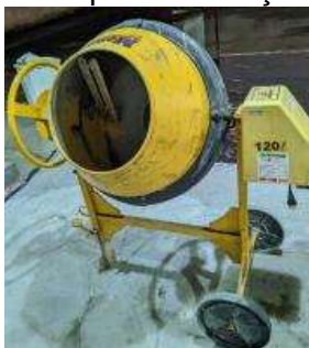
Figura 40 – Betoneira 120 litros utilizada para confecção dos concretos
