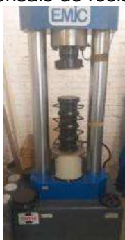
Figura 47 – Equipamento utilizado no ensaio de resistência à compressão
