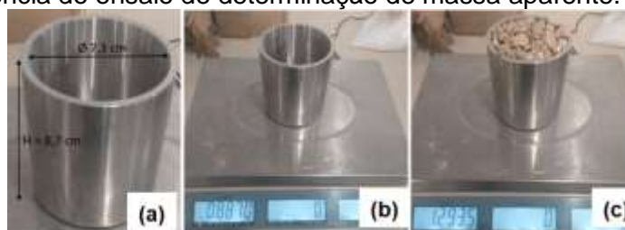
Figura 36 – Sequência do ensaio de determinação de massa aparente.
