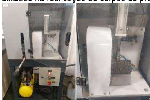
Figura 48 – Equipamento utilizado na retificação de corpos de prova cilíndricos
