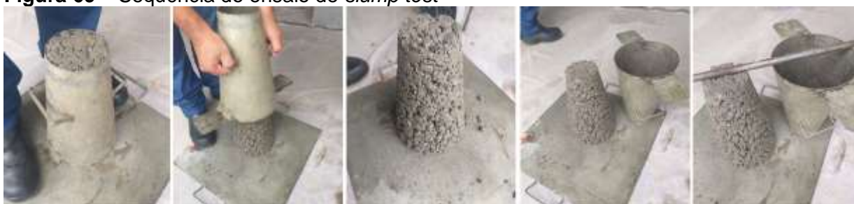
Figura 69 – Sequência do ensaio de slump test
