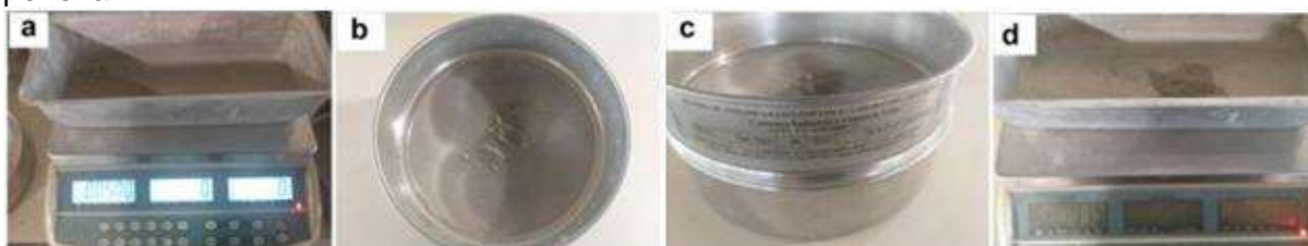
Figura 20 – Etapas do ensaio de módulo de finura: (a) pesagem do cimento; (b) peneiramento do cimento; (c) material retido na peneira; (d) pesagem do material retido na peneira.
