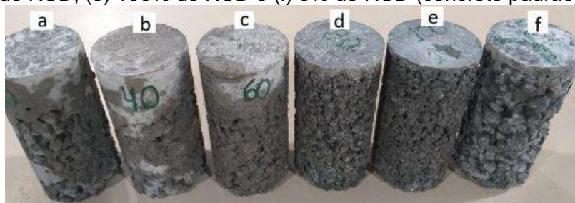
Figura 46 – Corpos de prova após cura: (a) 20% de RCD, (b) 40% de RCD, (c) 60% de RCD, (d) 80% de RCD, (e) 100% de RCD e (f) 0% de RCD (concreto padrão).
