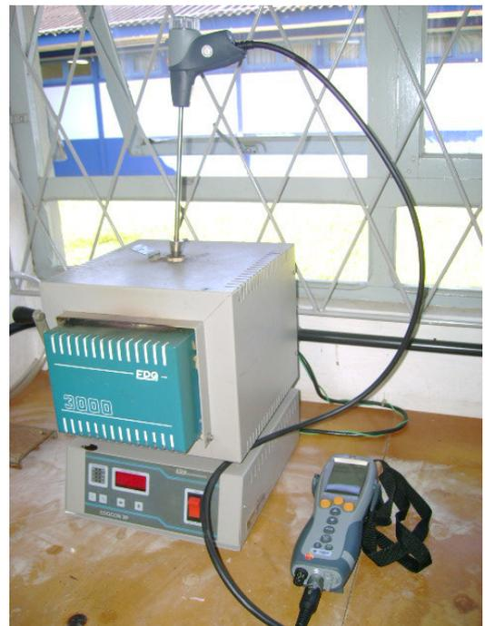
Figura 6: Equipamento TESTO - coleta e análise dos gases.
