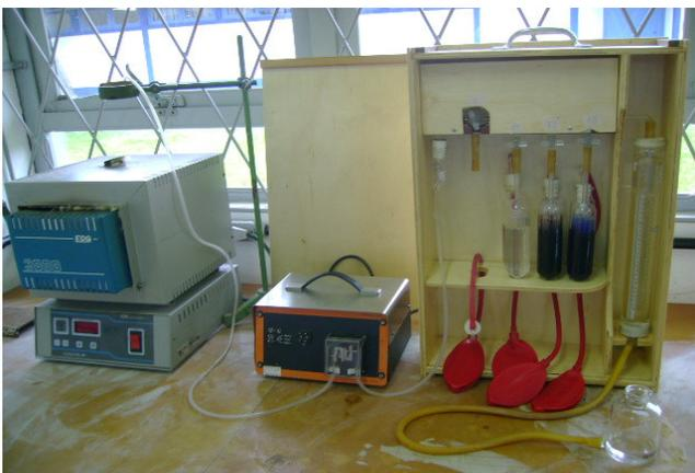
Figura 5: Aparelho Orsat utilizado na análise dos gases.
