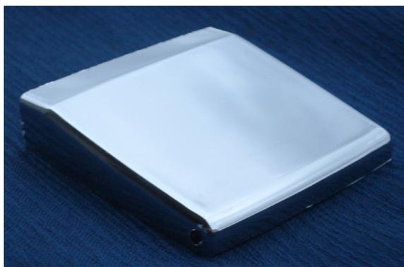
Figura 14: Foto de uma amostra aprovada nos testes de avaliação da qualidade do acabamento metálico.
