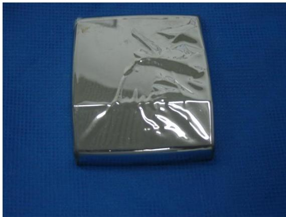
Figura 30: Foto da amostra cromada – efeito de encapsulamento
