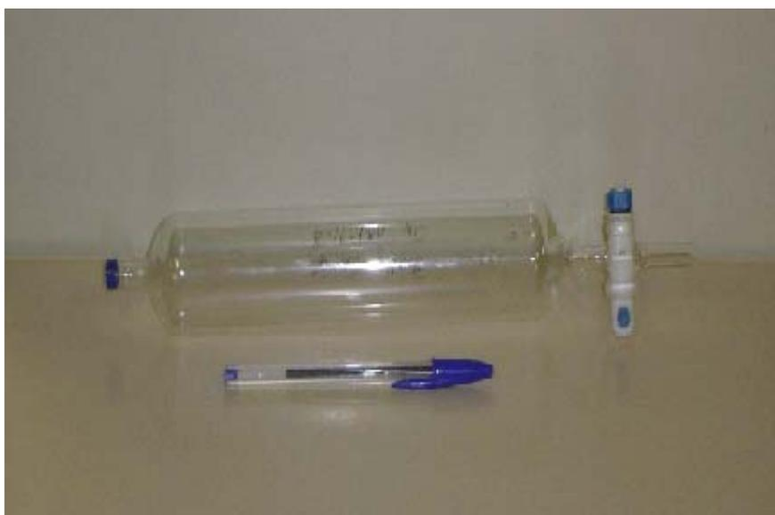
**Figura 8** – Ampola de vidro usada para a coleta de biogás
