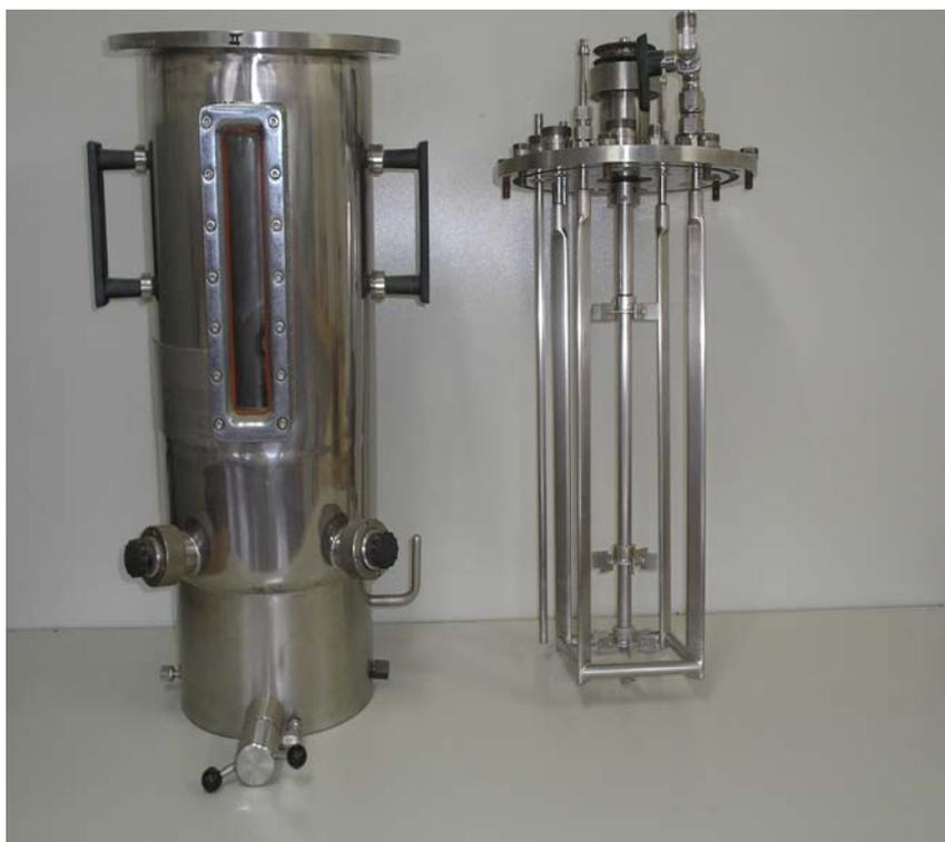
**Figura 6** – Dorna de 10L e sistema de agitação utilizados no biorreator New Brunswick, Ensaios E9 e E10
