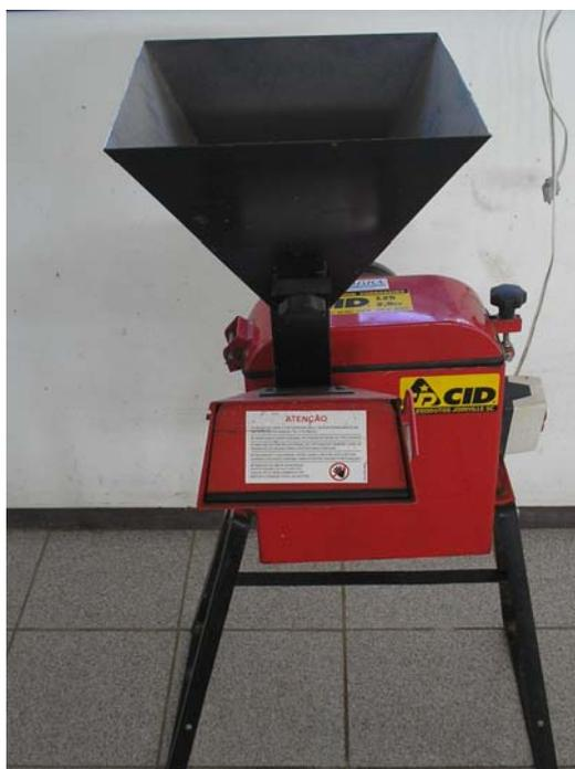
**Figura 3** - Triturador Forrageiro CID-125 empregado na operação inicial de cominuição das cascas de banana, engaço, folhas e pseudocaule da bananeira
