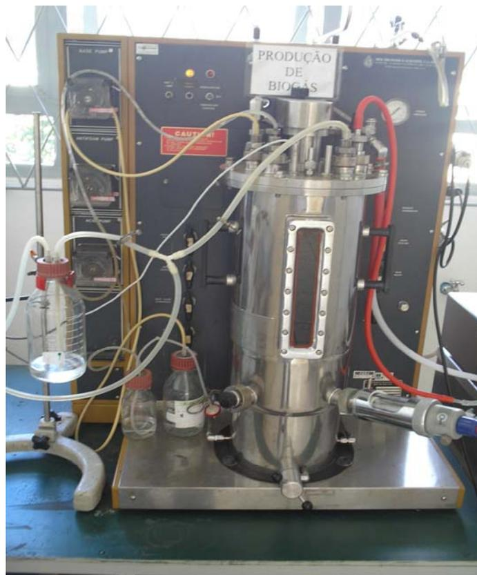
**Figura 5** – Biorreator New Brunswick empregado como biodigestor nos Ensaios E9 e E10: sistema em operação.
