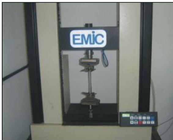
Figura 14: Equipamento utilizado nos ensaios de tração.
