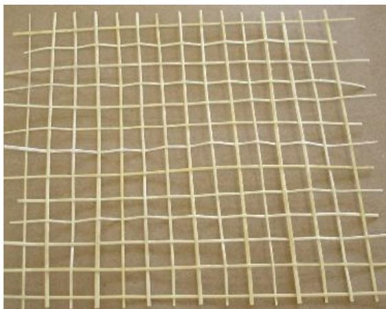
Figura 8: Fibras já tramadas e ajustadas com espaçamento de 1 cm.
