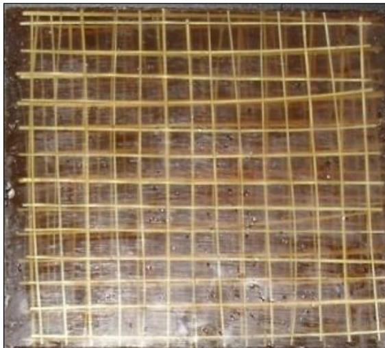
Figura 9: Placa do compósito híbrido confeccionado para ensaio de impacto.
