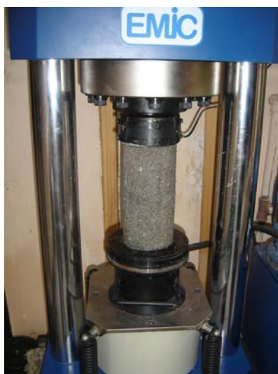
Figura 4. Equipamento de ensaio de compressão alocado na empresa Testecon Análise Laboratorial de solo, na cidade de Blumenau – SC.
