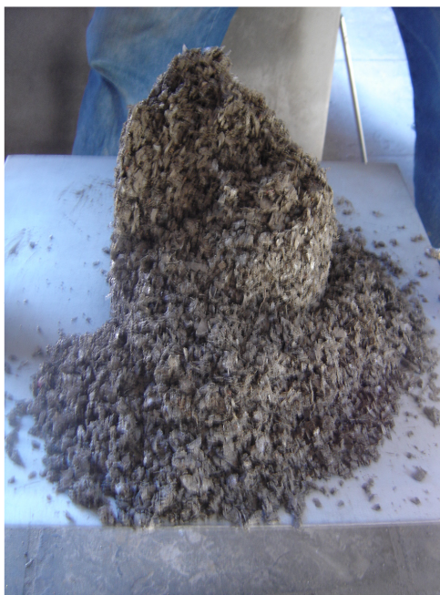
Figura 5 – Fotografia evidenciando o colapso de amostra com fração de substituição de agregados de 10% de resíduo Filme de PET, submetida ao ensaio de abatimento.
