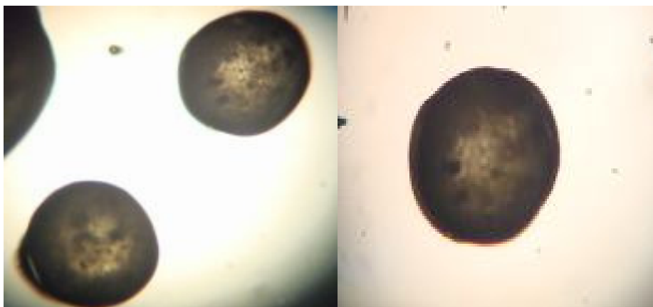
Figura 21 - Microscopia óptica das microesferas de Gel/CMC com ampliação de 40 x após filtração G5 (20%CMC; 5% glutaraldeído; 10% Piroxicam).
