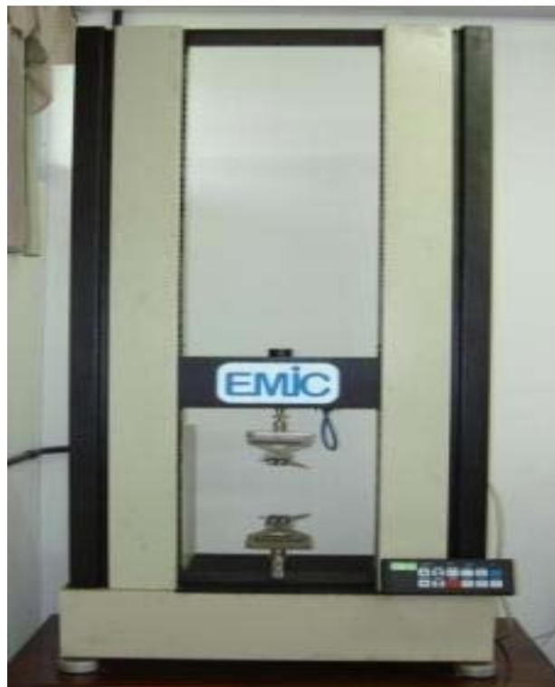
Figura 15. Máquina Universal de Ensaio EMIC modelo DL 10000/700.
