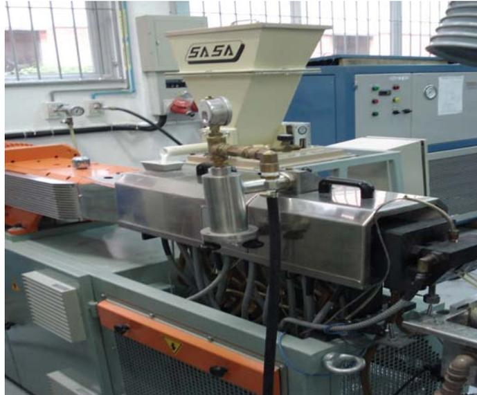
Figura 12. Foto da extrusora utilizada para pelletização das misturas.
