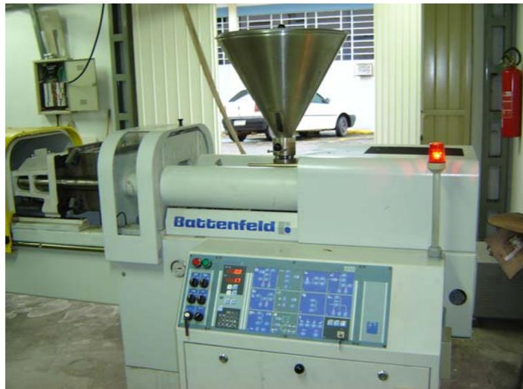
Figura 13. Injetora BATTENFELD BA 250/50 PLUS utilizada na injeção dos biocompósitos.
