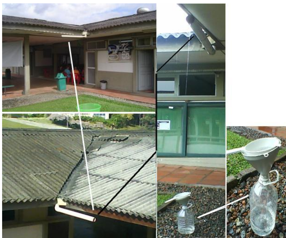
Figura 11 – Coleta de água de telhado no bairro Bom Retiro.
