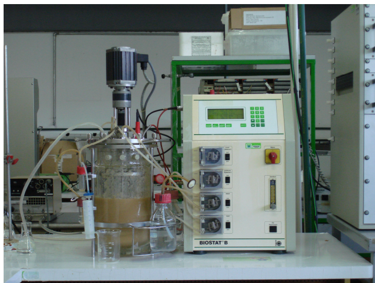
Figura 8 – Fermentador Biostat ® B da Braun.
