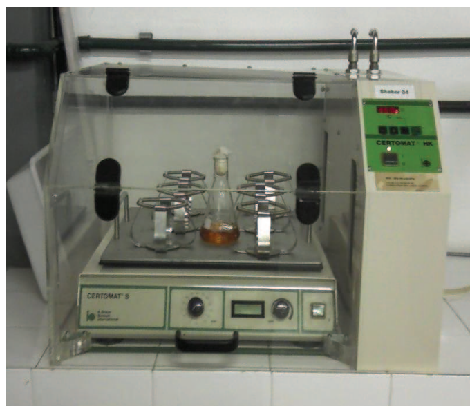
Figura 2.1 – Equipamento utilizado para o cultivo de Lactobacillus amylovorus em frascos erlenmeyer com e sem agitação.
