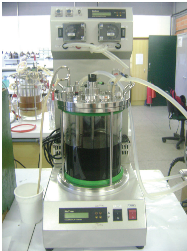
Figura 2.2 - Biorreator utilizado no processo de cultivo de Lactobacillus amylovorus visando à síntese de ácido láctico.
