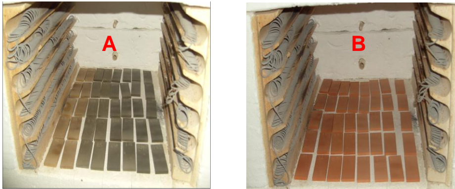
Figura 10: Corpos de prova antes da queima (A) e após queima (B) dentro do forno.
