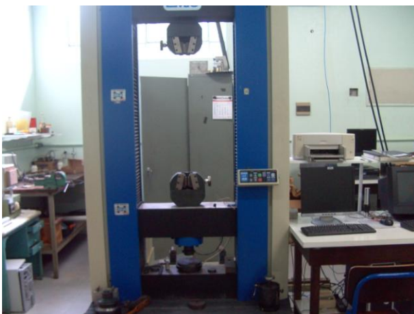
Figura 12: Equipamento para compactação dos corpos de provas e análise de flexão de ruptura.
