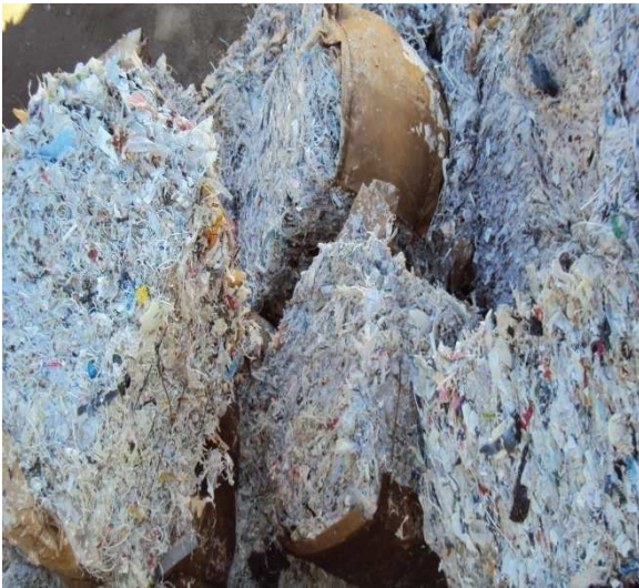
Figura 9. Resíduo da descontaminação das aparas
