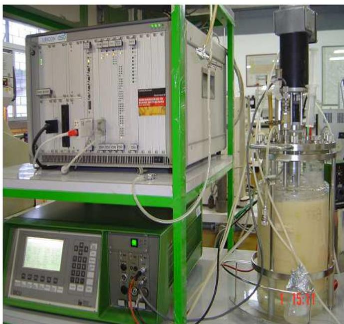
Figura 12: Biorreator utilizado no processo de cultivo de *Cupriavidus necator*.
