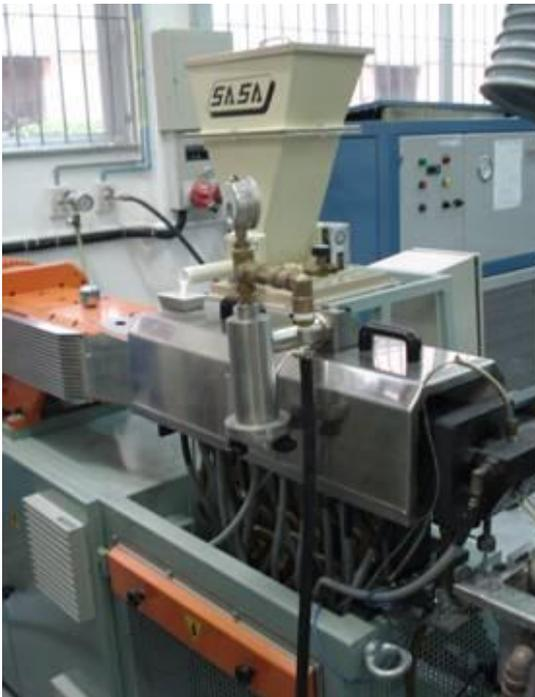
Figura 13. Extrusora utilizada para pelletização das misturas.
