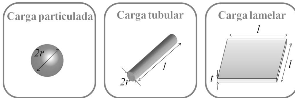
Figura 10. Ilustração esquemática mostrando a geometria típica de nanopartículas.
