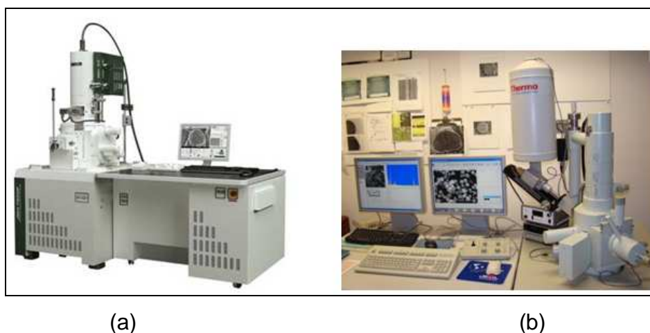
Figura 22 – Ilustração dos equipamentos (a) foto MEV, (b) foto EDS. (Fonte: Primária, 2011).
