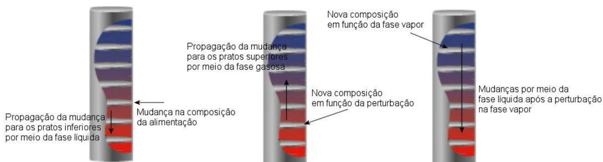
Figura 2: Ilustração do comportamento dinâmico de uma coluna de destilação decorrente de uma mudança na composição da alimentação.
