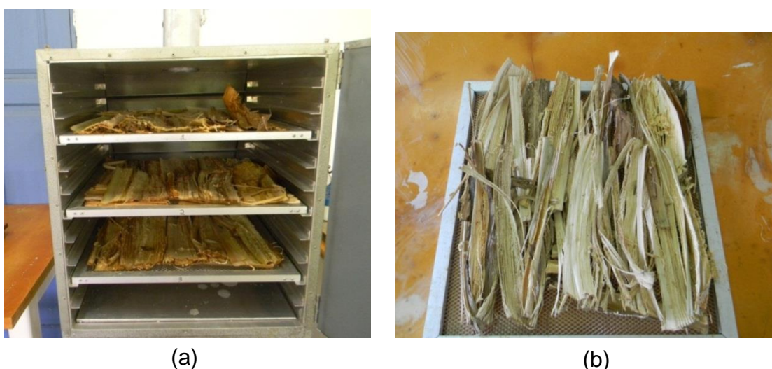
Figura 15 - Disposição das amostras de pseudocaule no secador (a) e amostras de pseudocaule após secagem (b).
