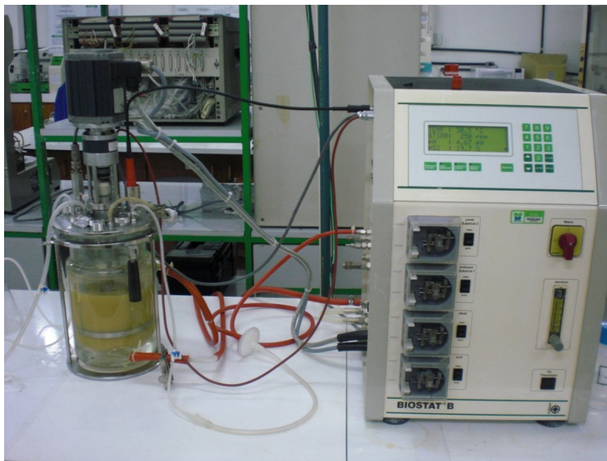
Figura 6. Biorreator utilizado no processo de cultivo de Kluyveromyces marxianus CBS 6556 visando a produção de lactase.
