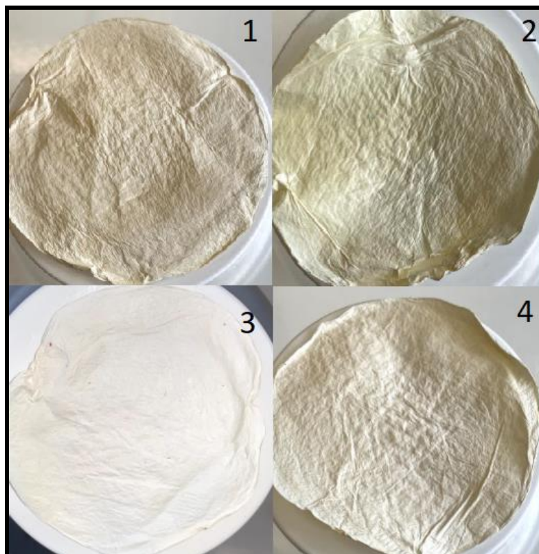
Figura 19 – Membranas de CB após incorporação de OEs (método com etanol) e secas: 1 – Cravo, 2 – Canela, 3 – Manjeriç o e 4 – Or gano
