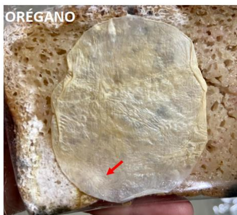
Figura 35 – Análise fúngica da amostra de CB com OE de orégano aplicada em pão após 14 dias de vencimento do mesmo
