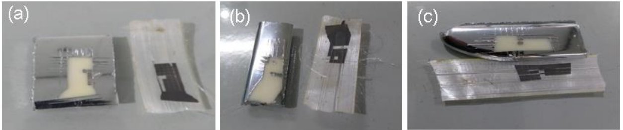
Figura 10 - Amostras condicionadas a 50 °C nos tempos de imersão de (a) 15 s, (b) 30 s e (c) 45 s.
