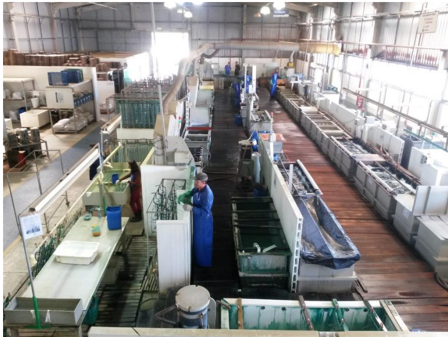
Figura 4 - Foto do processo de cromagem de peças em ABS de uma indústria galvânica.
