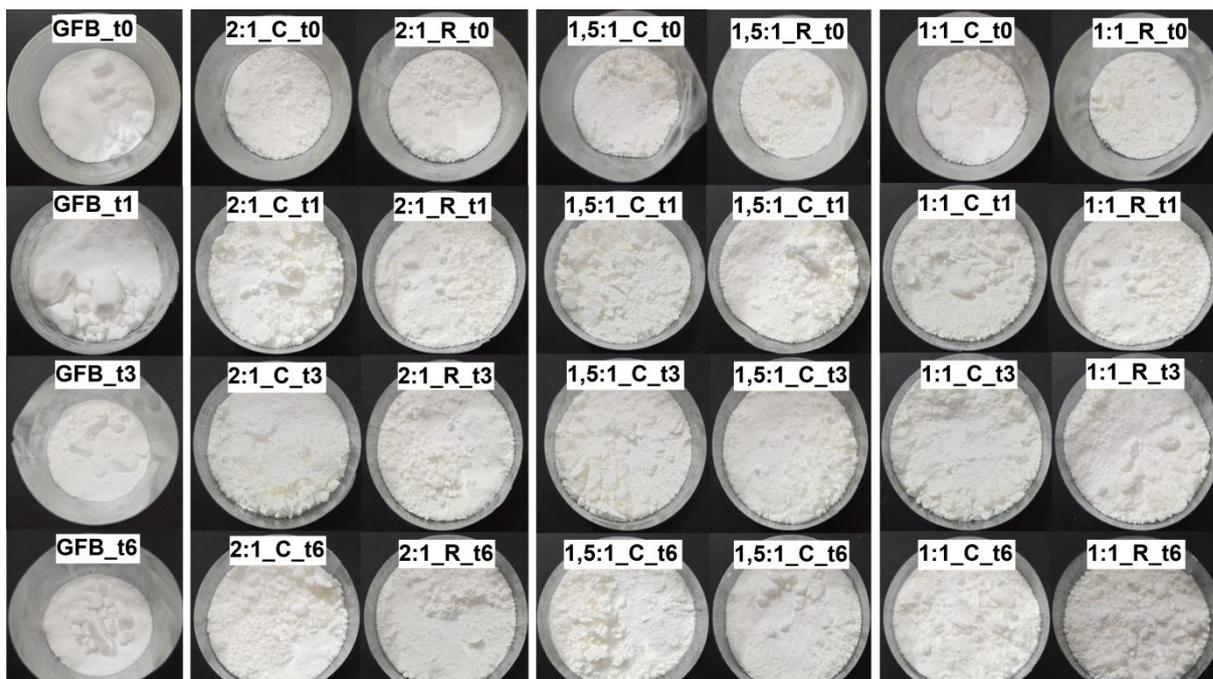
Os resultados mostraram alterações de cor quase imperceptíveis com a absorção de luz enquanto mantidas em temperatura ambiente, porém nota-se que houve absorção de umidade gerando a formação de aglomerados, estando os mais visíveis, indicados pelas setas vermelhas na figura. As DS são formulações muito sensíveis à umidade do ambiente (HUANG; DAI, 2013) e, mesmo armazenadas em recipientes fechados, podem adsorver esta umidade, uma vez que apresentam
