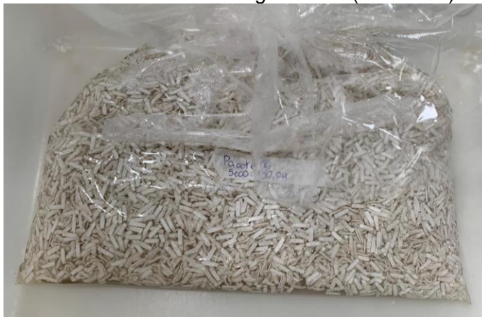
Figura 8 - Papel cartão SBS revestido com PET fragmentado (2 x 10mm) e imerso em água.
