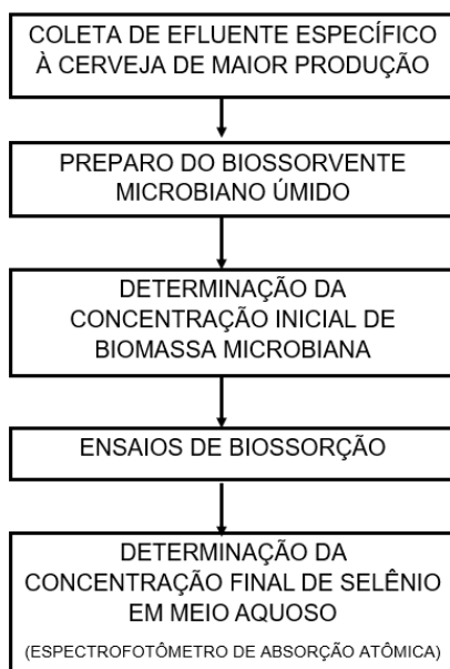
Figura 8 - Fluxograma do procedimento experimental utilizado nos ensaios de bioissorção inativa de selênio por levedura residual de indústria cervejeira
