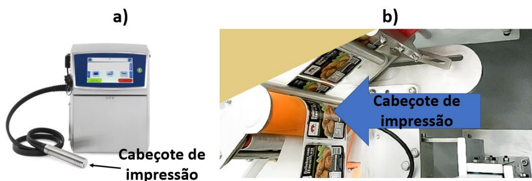
Figura 20 – (a) Impressora CIJ Linx 8900 ( Ink Jet Linx 8900 ); (b) Cabeçote de impressão imprimindo no filme antes de formar o saco
