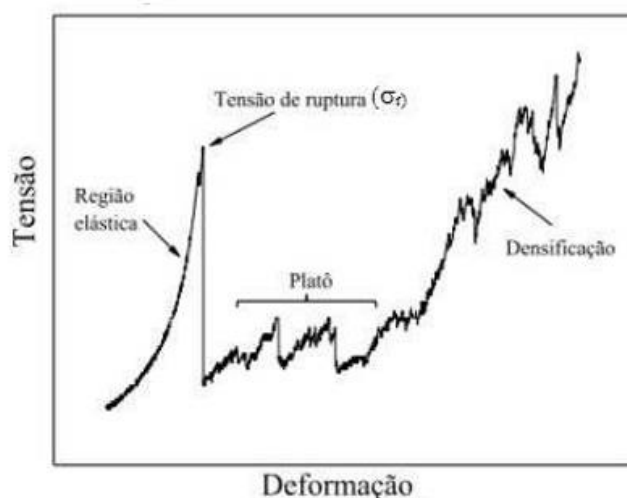
Figura 4 - Diagrama de tensão-deformação mostrando os estágios da resistência mecânica à compressão em espumas cerâmicas.
