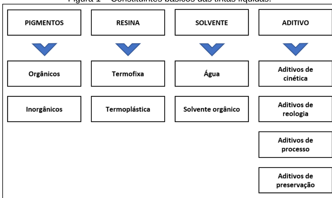
Figura 1 – Constituintes básicos das tintas líquidas.
