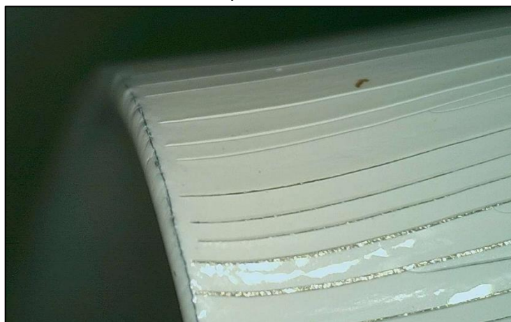
Figura 58 – Imagem ampliada da tinta com 1,5 % de NpsCu + MEG – TNS após o ensaio de flexibilidade por mandril cônico.
