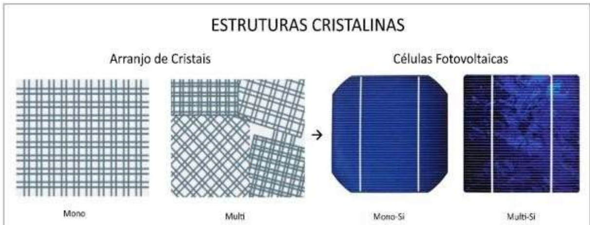
Figura 19 - Arranjo cristalino do silício solar e fabricação das células
