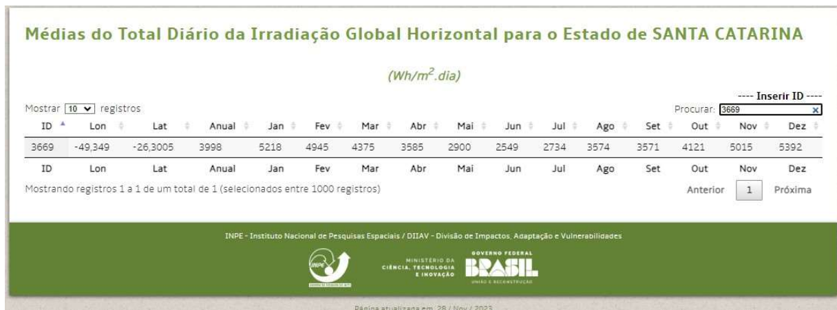
Figura 12- Mapeamento solar diário médio de Santa Catarina em específico a região de São Bento do Sul
