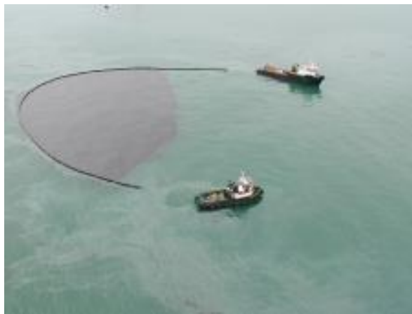
Figura 3: Barreira de contenção de óleo aplicada em acidentes ambientais.
