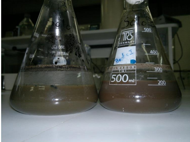
Figura 16: Cultivo submerso em frascos agitados com 150 \text{ min}^{-1} e 30 \text{ }^\circ\text{C} .
