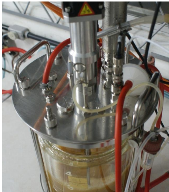
Figura 17: Disposição dos aparatos na tampa do biorreator STR.
