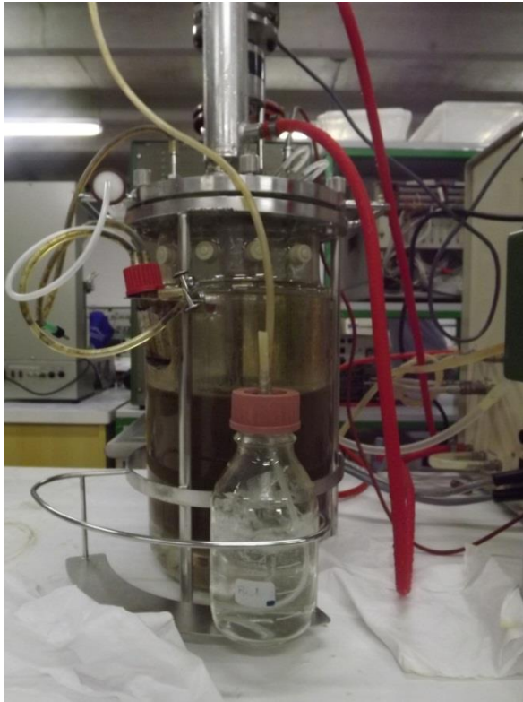
Figura 25: Biorreator STR, montado para experimento de degradação do petróleo.
