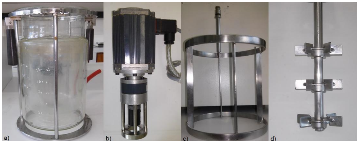
Figura 8. Equipamentos para cultivo em biorreator: a) vaso de cultivo de 2 L; b) motor de agitação; c) chicana e d) turbinas de Rushton.
