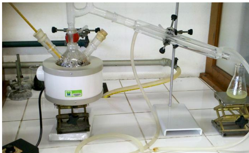
Figura 17. Destilação da fase densa do bio-óleo.
