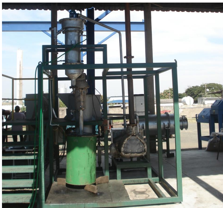
Figura 14. Planta de pirólise rápida Modelo PPR-10.
