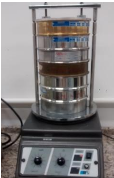
Figura 19: Análise de granulometria realizada no agitador de peneiras Bertel.
