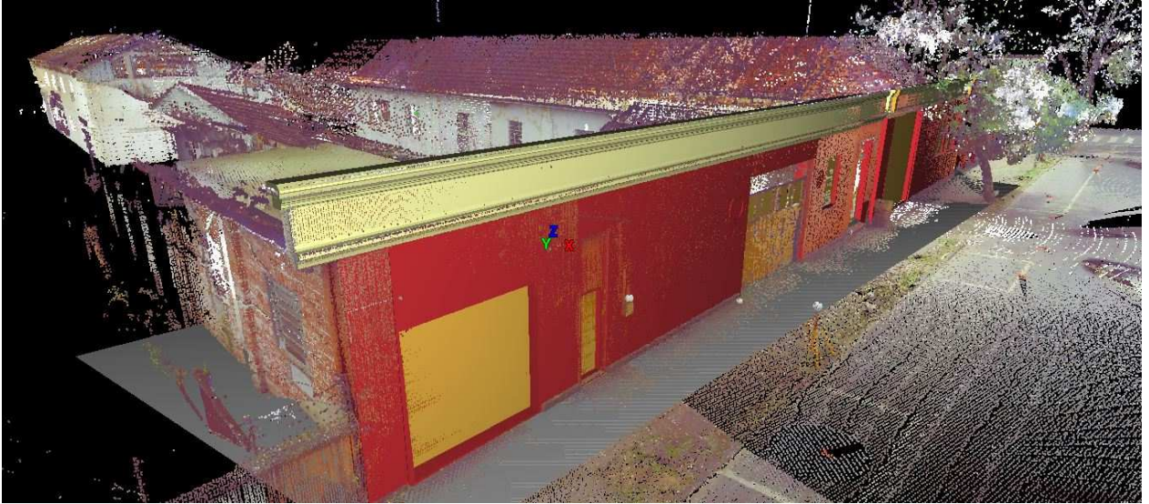
Figura 9 - Nuvem de pontos com remodelagem de fachada.
