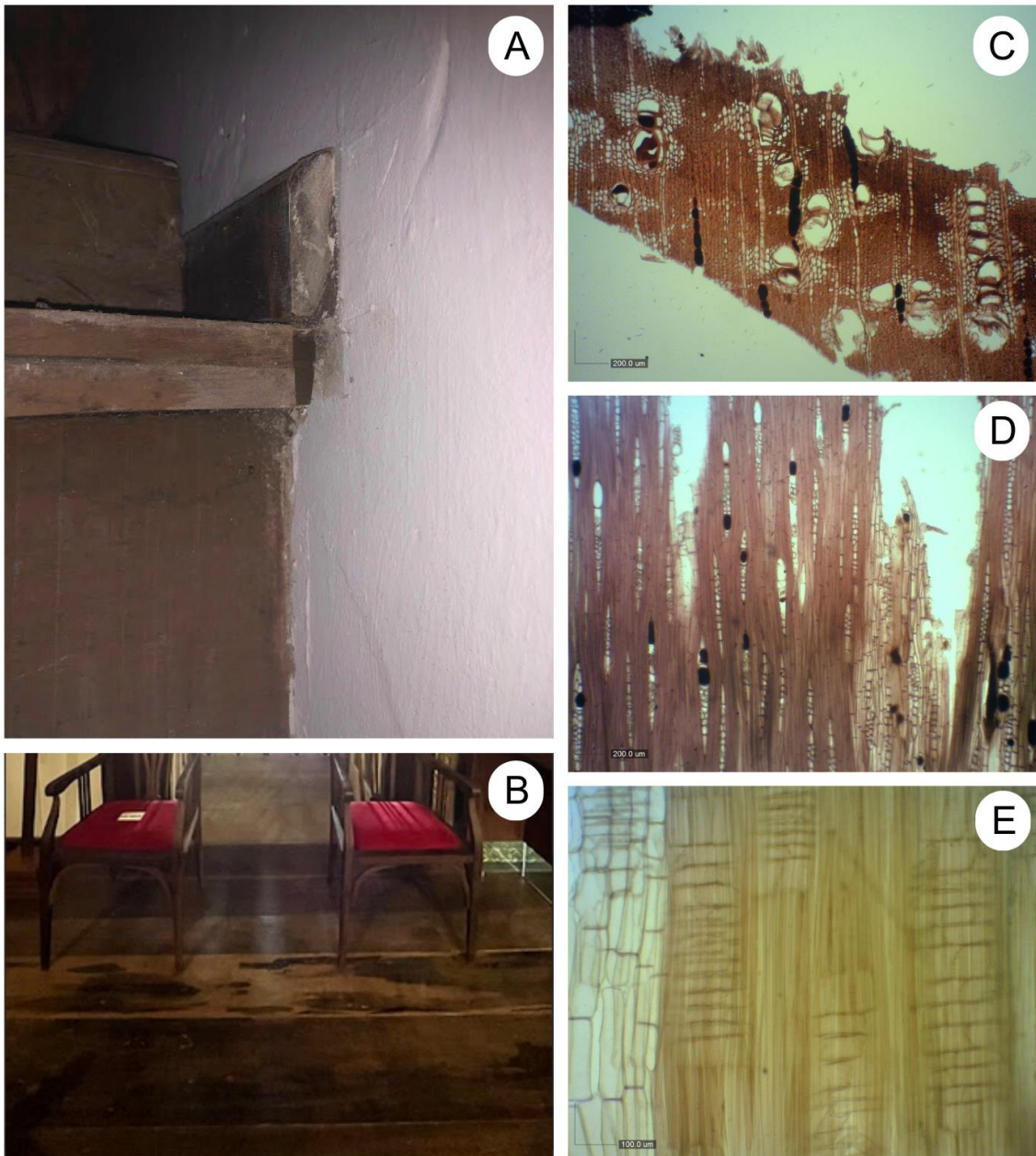
Figura 10 - Elemento construtivo e respectiva anatomia da madeira de Ocotea cf. cymbarum . (Lauraceae), Igreja Nossa Senhora da Graça, São Francisco do Sul, Brasil. Legenda: A - Piso do assoalho. B – Assolho do mezanino. C - Secção transversal. B - Secção longitudinal radial. E - Secção longitudinal tangencial.
