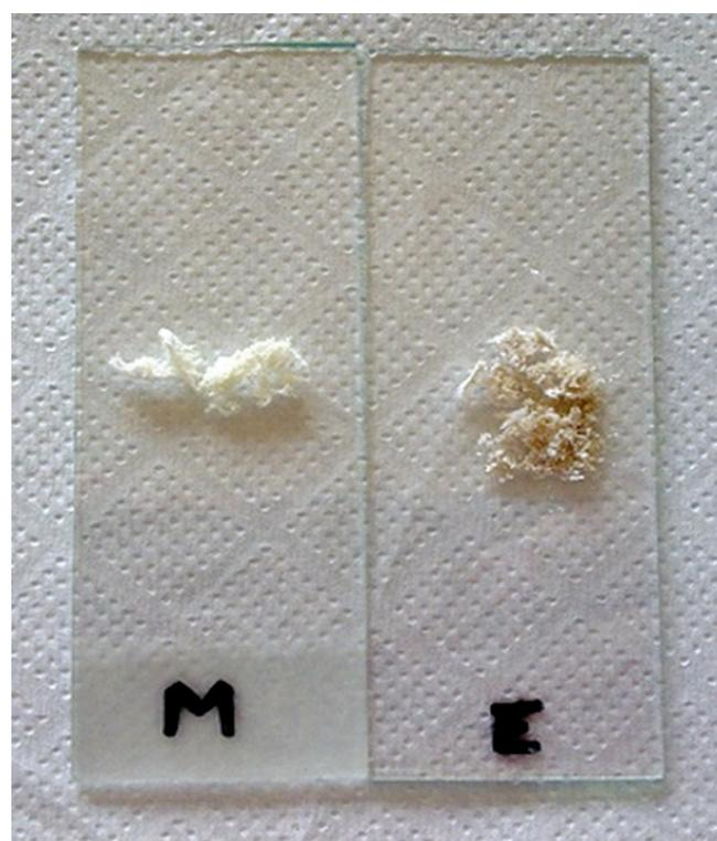
**Figura 1** – Amostra da matriz de P(3HB)/PCL pura (M) e da matriz com fração III-II (E)
