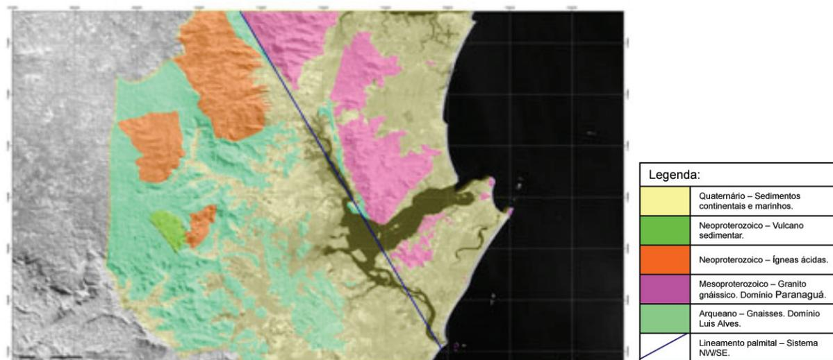
**Figura 2** – Esboço do mapeamento geológico-estrutural da área de estudo. Observam-se em destaque o lineamento palmital, limitando o terreno do domínio Paranaguá e do domínio Luis Alves, e também a ocorrência de afloramentos do domínio Luis Alves a leste do lineamento palmital
