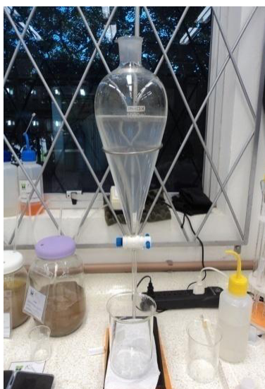
Figura 3 – Água contaminada em funil de decantação
