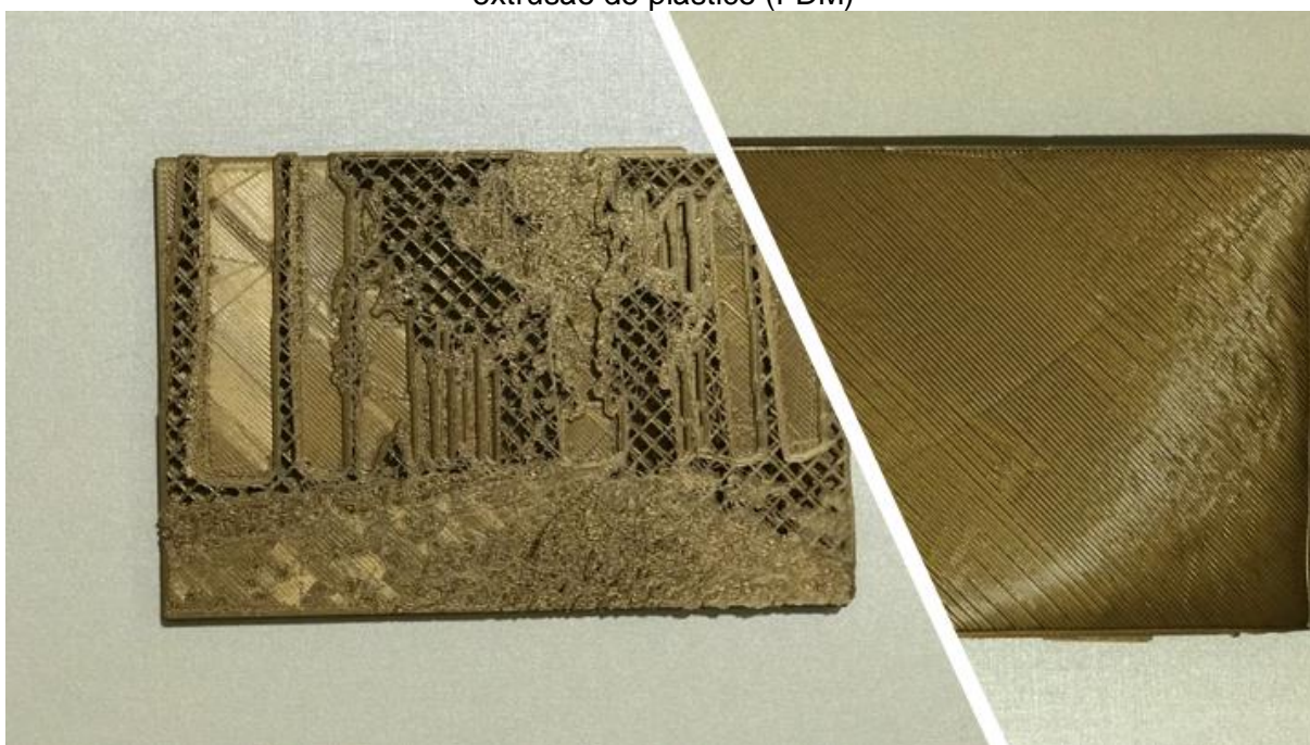
Figura 21 – Resultado do teste de impressão na universidade pelo método impressão por extrusão de plástico (FDM)
